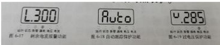
6.4.8 【确认】：参数设置及密码输入状态时做确认功能使用。在轮显或跳闸停显状态时，按下【确认】键，进入密匙校验状态，密匙校验成功后允许进入参数设置。按下【◀】、【▶】键实现光标移动，按【▲】、【▼】键实现改变参数值。按【确认】键保存，并进入下一项设置，按【复位】键放弃设置，并退出设置状态。可设置额定剩余电流 (L.300)，额定极限不驱动时间 (t.300)，剩余电流突变保护值 (E.50)，额定电流 (r.400)，过载长延时时间 (d.012)，短路延时倍数 (r2.06)，短延时时间 (S.200)，瞬时倍数 (r3.08)，过电压整定值 (u.275)，欠压整定值 (n.165)，缺相整定值 (p.120)，定时试跳时间 (25.00)，当前年月 (14.04)，当前日时 (18.20) 当前分秒 (25.32)，通讯地址后 4 位 (0000)，通讯波特率 (2400) 用户密码 (9119) 共 18 项参数。如图 6-20、6-21、6-22、6-23、6-24、6-25 所示。
