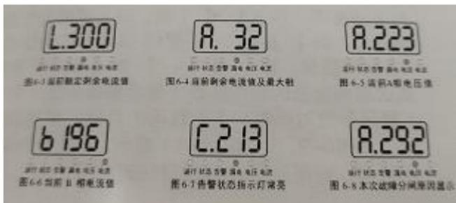
6.3.2 剩余电流超限告警。保护器告警指示灯闪烁时，表示当前剩余电流已经超出剩余电流告警整定值，告警显示如图 6-7 所示。
